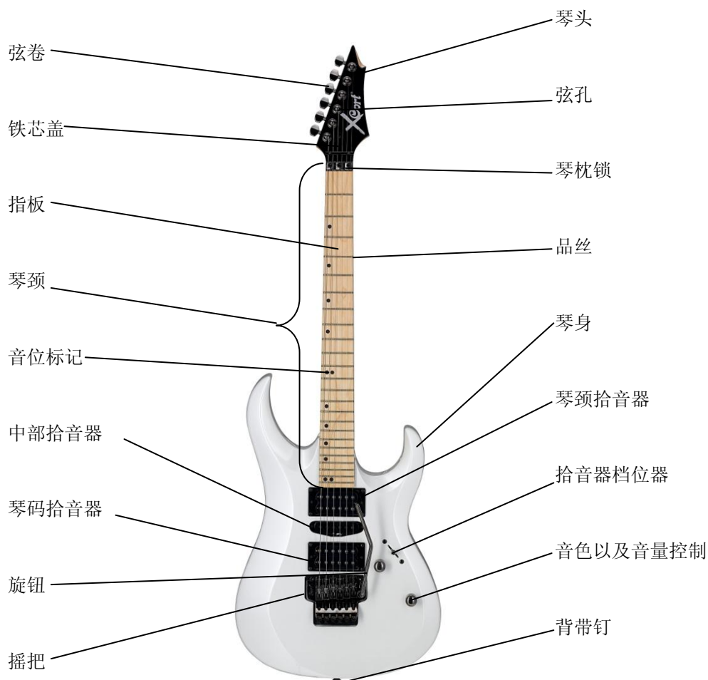
电吉他零部件示意图
