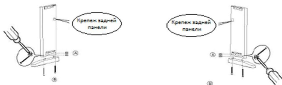
Поместите четыре цилиндрических гайки (A) в отверстия на ножках стойки так, чтобы прорезь была обращена наружу. С помощью отвертки совместите резьбу в гайках с отверстиями в нижней части ножек стойки.
