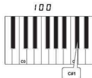
Поворачивайте регулятор Data Control по часовой стрелке, чтобы увеличить громкость метронома, или против часовой стрелки, чтобы уменьшить громкость метронома. Уровень громкости метронома будет отображаться в виде значения от 0 до 127 в окне светодиодного дисплея.
