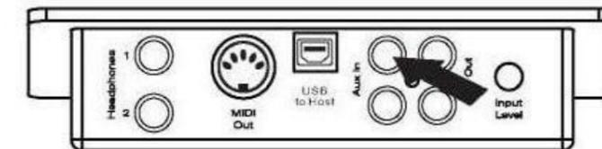
Уровень сигнала Aux In можно регулировать при помощи контроллера Input Level.
