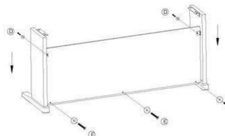
С помощью двух болтов задней панели (D) с шайбами и трех болтов задней панели (E) с шайбами прикрепите заднюю панель к стойке. Пожалуйста, обратите внимание, что в педальной клавиатуре не надо предварительно сверлить отверстия для винтов задней панели, их необходимо вкручивать вручную.
