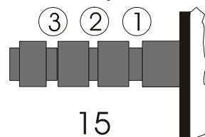
Сдвиньте петлю на ните груза антискейтинга до третьей отметки шкалы, чтобы установить компенсирующую силу антискейтинга соответствующей установленному на предприятии-изготовителе звукоснимателю. Проденьте нить в петлю проволочного суппорта (17).
