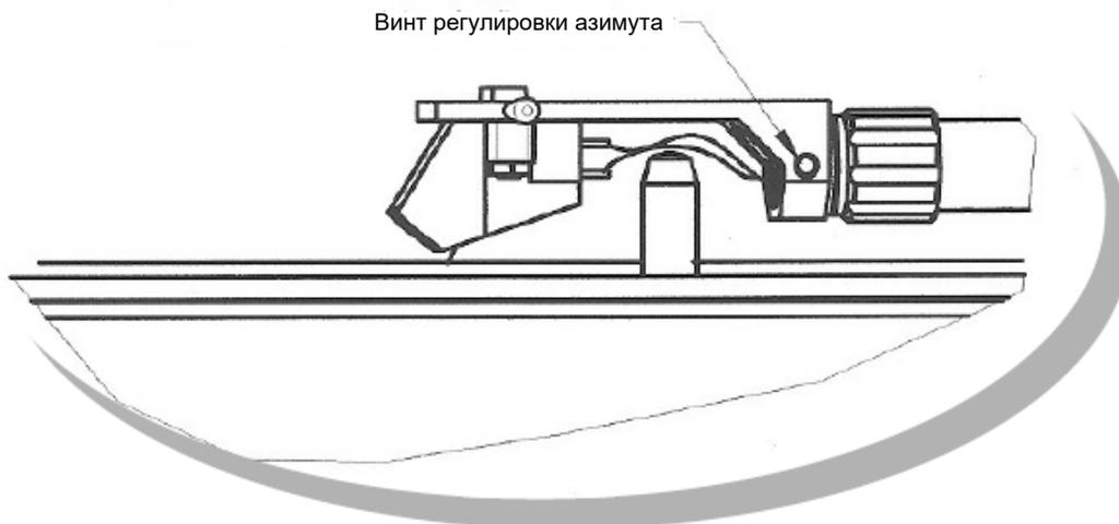
Если корпус картриджа отклонен в левую или правую сторону, ослабьте винт азимута и аккуратно поверните корпус головки звукоснимателя в противоположную сторону. При правильном положении корпус картриджа параллелен зеркалу (пластинке). После завершения настройки затяните винт азимута и начните воспроизведение!
