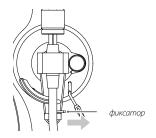
6 Поднимите рычаг тонарма (микролифт).
